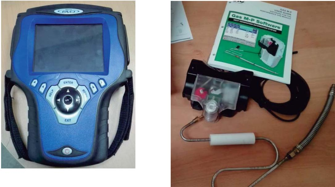
Figura 2.0 Sistema de medición de gases contaminantes a) Escaner Automotriz Genesys NGIS b) Modulo de Analisis de Gases M-P.
